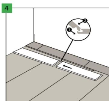
Podlahové panely Afirmax jsou vybaveny spojovacími zámky na dlouhé i krátké straně. Nejprve spojte panel dlouhou stranou a za této účelem zasuňte dlouhou stranu panelu do drážky dřívě namontovaného panelu. Posuňte jej k rohu a ponechejte nevelkou vúli.
