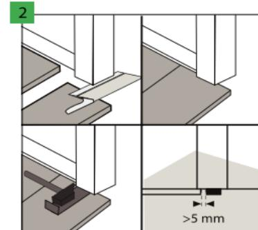
Dilatační spáry podél stěn musí být uzavřeny dekorativní lištou, připevněnou lepidlem nebo speciálními sponami. Doporučuje se použít dekorativní lišty Afimax určené pro tento panel, které zaručí vynikající barevnou shodu a odolnost proti poškrábání.
