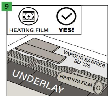
Desky je možné montovat také na topnou fólii. V takovém případě je nutné použít vhodný podklad pod topnou fólii a parozábranu SD ≥75 na topnou fólii. Celý systém obsahuje paroizolační fólii, která se pokládá přímo na podklad, vhodný podklad (min. 400 kPa, doporučená tloušťka 5 mm), topnou fólii, paroizolační fólii a podlahovou krytinu.
