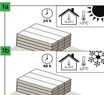
Pokud bude během dopravy teplota  $> 5^{\circ}\text{C}$ , bude aklimatizace při teplotě  $18\text{--}30^{\circ}\text{C}$  trvat 24 hodin (v místnosti, kde proběhne pokládka). Pokud bude během dopravy teplota  $\leq 5^{\circ}\text{C}$ , bude aklimatizace při teplotě  $18\text{--}30^{\circ}\text{C}$  trvat 48 hodin.
