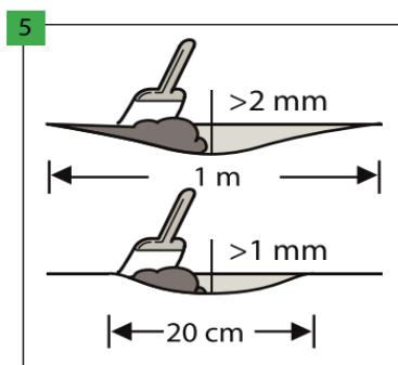
Ujistěte se, že základna je zcela rovná. Všechny nerovnosti podkladu přesahující 1 mm a přesahující 20 cm na délku nebo přesahující 2 mm a přesahující 1 m na délku musí být vyrovnány. Zkontrolujte, zda je třeba použít základní nátěr nebo izolační materiál. Pro přípravu dokonalého podkladu naneste na celý povrch cementovou maltu nebo samonivelační hmotu.
