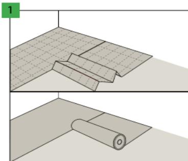
Podklad "Arbiton", "Ewifoam" nebo "Afirmax" položte kolmo ke směru pokládky panelů. Sousední řady podkladové podložky by k sobě měly těsně přiléhat a měly by být spojeny překrytím nebo páskou Arbiton AluTape bez jakékoli mezery.
