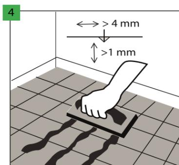
V případě instalace na keramický obkladový podklad, švy se spárami širšími než 4 mm a hlubšími než 1 mm zalijte trvanlivou spárovací hmotou, jako je pryžová spárovací hmota. Schváleno pro instalaci na dlaždice se spárovací hmotou ne širší než 5 mm a ne hlubší než 1 mm bez použití stěrkové hmoty při použití jako podklad „Multiprotec Hardlay“ nebo „Vinclic Solid“. V případě pokládky na povrch pokrytý keramickým obkladem vypříte spáru obkladů a napenetrujte celý povrch.
