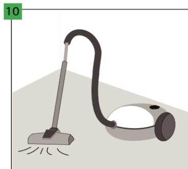
Ujistěte se, že podklad je suchý, rovný, stabilní a bez mastnoty nebo chemikálií. Odstraňte nebo vyhlaďte výčnívající nerovnosti. Před instalací pečlivě zameďte a vysaje podklad, abyste odstranili veškeré znečištění. Případné vážnější vadu základu a velké trhliny je nutné opravit.
